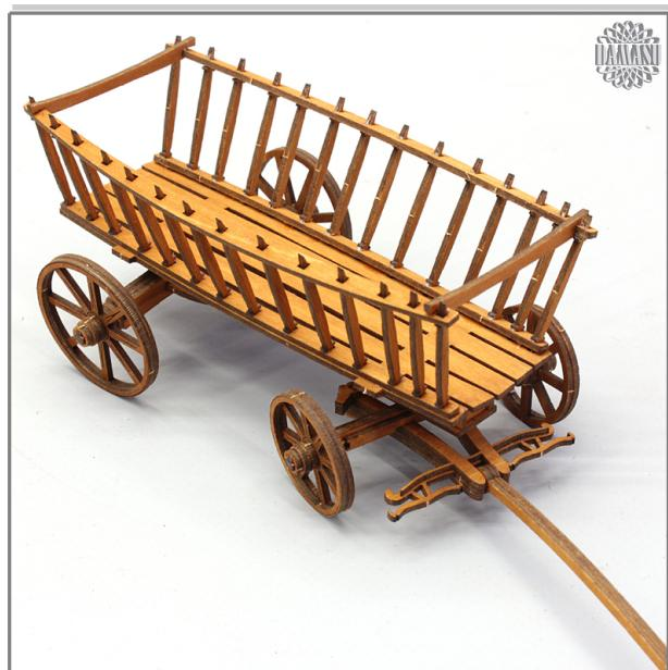
Die Deichsel wird in die bewegliche Vorderachse nur eingehangen. Sie wird nicht verleimt. Damit kann man die Zugtiere später vom Wagen trennen.
