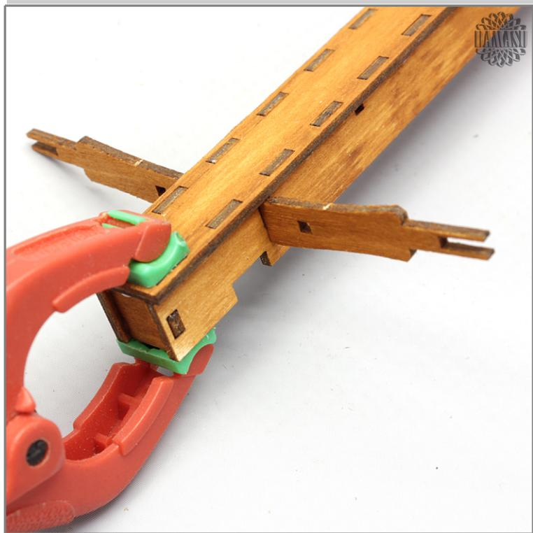
Die Hinterachse wird noch etwas verstärkt. Dazu werden auf beiden Seiten an das Mittelteil der Achse je ein weiteres Teil angeleimt und auch noch eine zusätzliche Verstrebung zum Mittelholm geführt. Zum Schluss werden auch noch die Achsenden verstärkt. Folgende Teile benötigen Sie dafür.
