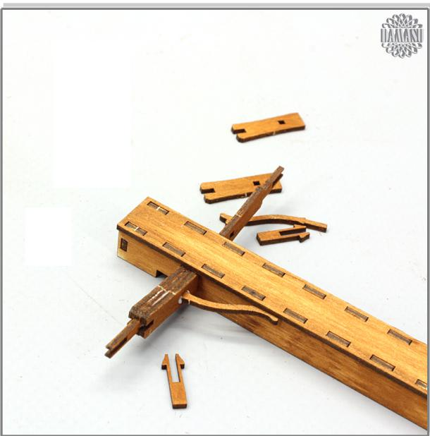
Danach leimen Sie auch das zweite Verstärkungsteil auf die andere Seite der Achse. Richten Sie die aufgeleimten Teile exakt nach dem Mittelteil aus.
